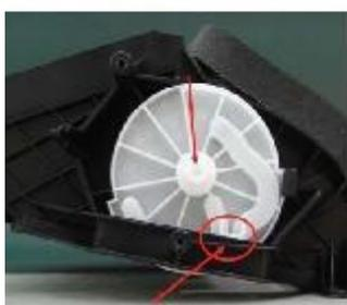
11 – Installare il nuovo meccanismo di comando, il fermo di arresto deve appoggiare sul telaio, come evidenziato dal circolino con la freccia.
