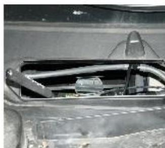
5 - Con l'aiuto di uno specchio ispezionare la parte inferiore del flap
