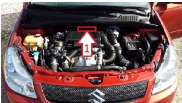
Posizione [VIN](#)Vehicle Identification Number - Numero di Telaio (Variante 2)
