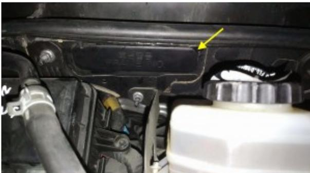
Il numero di telaio si trova punzonato sulla traversa sotto il parabrezza, come da figura.
